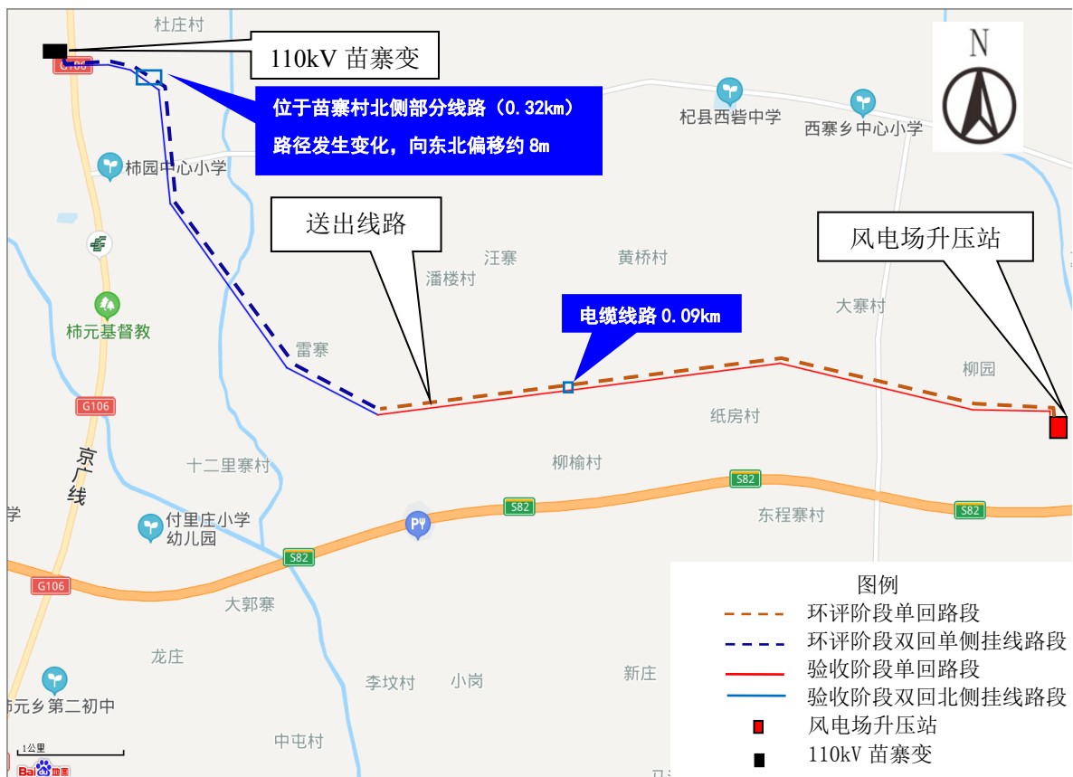
图 4-7 本工程环评阶段与实际建成变动情况示意图
