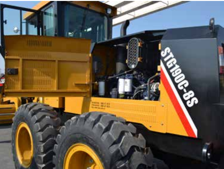
大开度发动机舱门及滤芯集中布置
