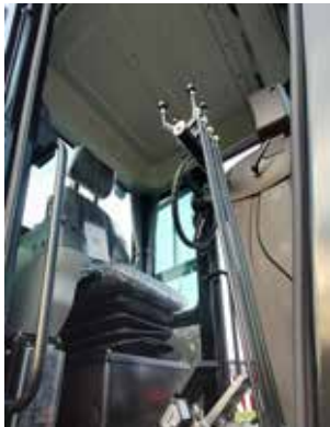
带头枕的机械悬浮式座椅
