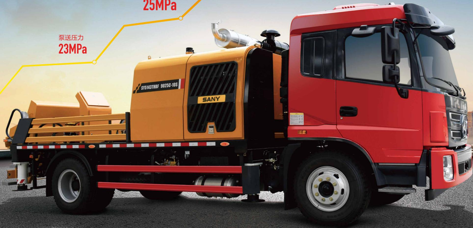
■ 出口压力设计由20MPa、23MPa提升至23MPa、25MPa
