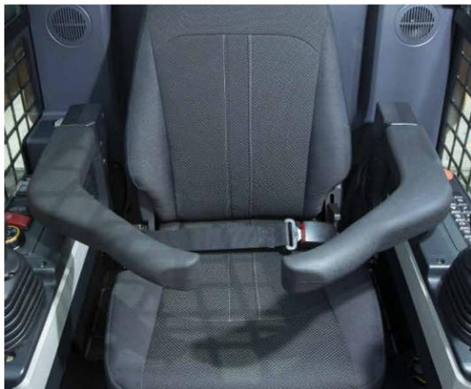
**安全扶手：**安全扶手放下，一键解锁后方可操作机器
