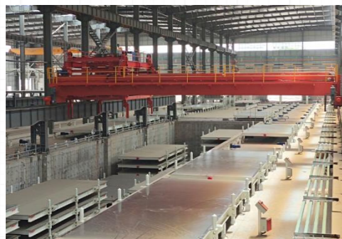
• 堆叠机及堆叠模台
