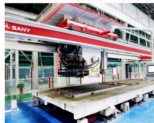
• 混凝土智能调度及布料振捣系统
