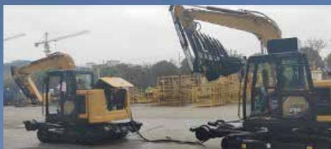
搭载三一自主研发应急邻车驱动系统，当发动机故障停车时，可使用邻车驱动专用管路快速与邻车相连，借助邻车动力，驱动故障车辆，保障作业线路畅通。
