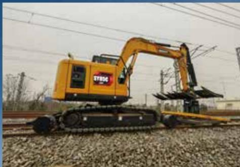
双驱动：适应标准轨距（1435mm），履带驱动 / 钢轨轮驱动可一键切换。
