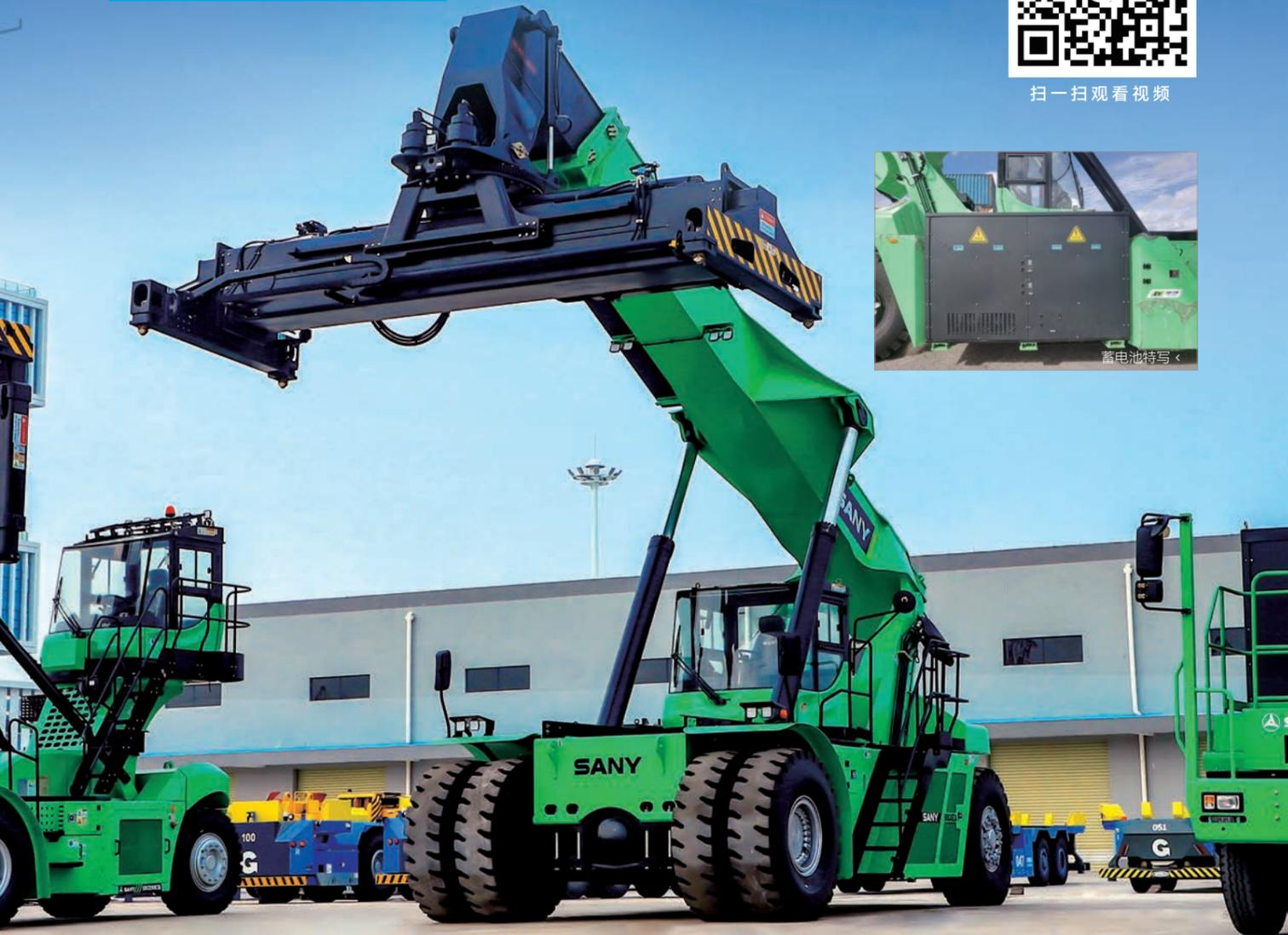
1 搭载外置式换电箱，10min 可完成电池更换，迅速补能，检修方便。
