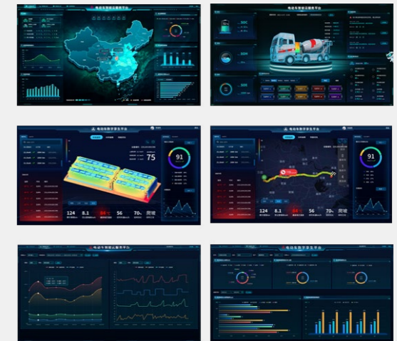
电动搅拌车数字孪生系统实现能耗可视化
