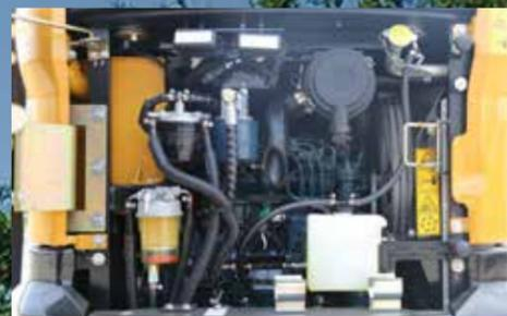
SY16C 搭载久保田发动机，满足国四排放标准，功率高达 15.4kW，保障强劲的动力输出，可靠耐用。
