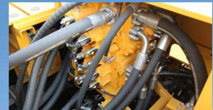
采用三一定制电控多路阀，高响应性、低压损。
