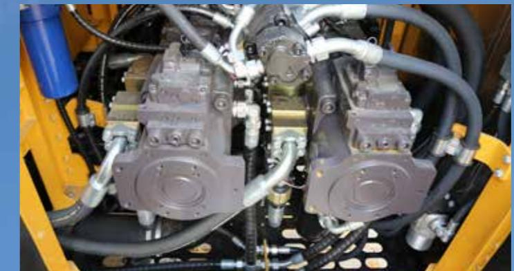
采用三一定制双联柱塞泵组，大排量，低压损。
